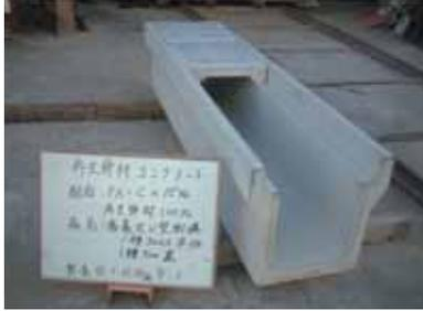
**再生粗骨材Mをプレキャストコンクリートに限定利用すれば、寒冷地でも利用可能**
