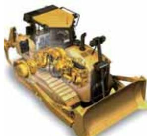
D7Eブルドーザは「ディーゼルエレクトリック駆動」というブルドーザで世界初の駆動方式を採用。ディーゼルエンジンで発電機を駆動し、発電した電気をパワーインバータ等の装置を利用することにより制御し、走行モータを駆動させます。この駆動方式はエンジンに直接作業負荷が伝わらず、ほぼ一定回転で効率的な発電が可能なので燃料消費とCO<sub>2</sub>排出量を約20%削減できます(低炭素建設機械の指定)。また、従来のトルクコンバータやトランスミッションがない構造で稼働パーツを約60%削減し、機械経費の削減にも貢献します。
