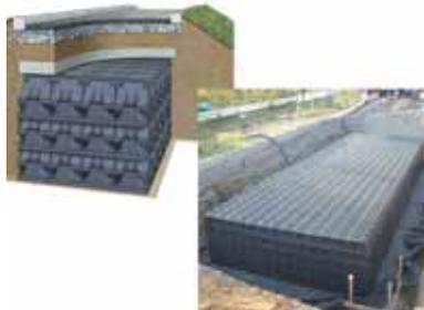
建設技術審査証明を取得した道路下に適用可能な樹脂製貯留浸透槽です。道路冠水対策や輪荷重が作用し強度が必要な造成地への使用が可能です。また港湾護岸等の水位が高い場所での軽量盛土としての使用が可能です。EPS工法との併用も可能です。復旧・復興に関しては、道路直下に貯留浸透槽が求められる交差点部や駐車場、地下水位が高い場所の軽量盛土としての使用、アンダーパス部の冠水対策等にご採用が可能です。
