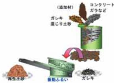
回転式破碎混合工法は、円筒内で高速回転する複数本のフレキシブルなチェーンの打撃力で、材料を破碎・細粒化（解砕）すると共に、添加材料を均一に分散させることにより破碎と混合とを同時に行うことが可能な工法です。回転式破碎混合工法を用いることで、ガレキの混入する粘性土主体の津波堆積物、高含水比津波堆積物などを団粒化させずに解きほぐして土砂とガレキを分離し効率よく分別することができます。また、必要に応じて土壌改良材、土壌浄化剤（不溶化）、リサイクル材等の添加材料を同時に破碎混合処理することが可能です。
