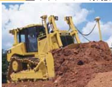
ICT(情報通信技術)を活用しデータ化された現場設計図を施工時に利用することで、より高効率で高精度な施工を実現します。更に通常建設機械への情報化施工機器の取付は非常に煩雑ですが、CATのARO(AccuGrade Reedy Option)仕様は、必要な配線・ブラケット・モジュール類を予め車両本体に組み込んでいる為に、短時間で取付が容易に可能です。また、建設機械と一体で開発されたマシンコントロール&ガイダンスは建設機械と同じく厳しい環境で長期間使用されることを前提に設計されており耐久性や耐震性に優れています。
