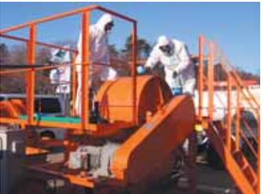
放射性物質で汚染された廃棄物を、「廃棄物洗浄機」および「摩砕洗浄機」を使用して洗浄し、対象瓦礫の放射能濃度を低下させ、一般の焼却施設にて焼却等が可能な廃棄物にするなど、中間貯蔵施設へ搬入する廃棄物の量を減らすことを目的とする技術。
