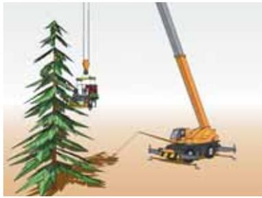
**放射性物質の堆積した樹木の枝や葉を、遠隔操作により剪定及び除去して、被ばく線量を低減しながら除染が可能です。**
