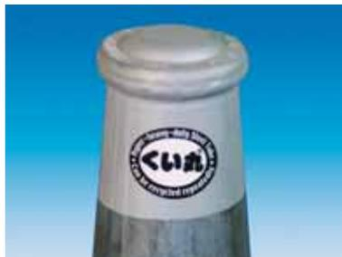
「くい丸」は、単管(足場管)の約2.5倍の支持力を持つ、強力な打込み杭専用材です。先端が尖っているので施工しやすく、アスファルトや鉄道バラスト等の難地盤に施工することができます。短期(花火大会・スポーツイベント・仮設等)で使用する場合には繰り返し使用することができるメリットがあり、また、中長期(太陽光発電の架台の基礎杭・土留め等)で使用する場合には、サビに強く雨水の溜まらない密閉構造により高い性能を発揮します。
