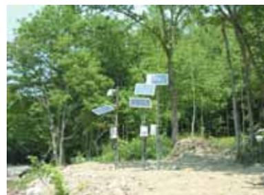
最新技術を結集したオリジナルのデータロガーは1台で最大10種類の計測ができます。現場のさまざまな状況をリアルタイムで計測し、「安全対策」「環境対策」「品質管理」の自動化を行うシステムです。計測データは遠隔地からWEB上で監視し、データの収集・分析を行い、同時に警告などの制御ができます。また、スリープモードと起動モードの自動モード変更により、低消費電力を実現し、日が短い厳冬の北海道でもソーラー電源のみで稼働可能な、他に類を見ない画期的なエコシステムです。
