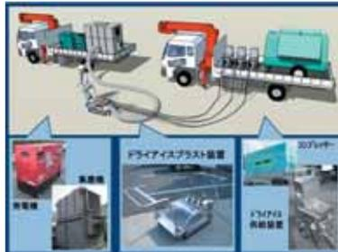
**ドライアイスの粒を舗装面に吹付け、気化時のエネルギーを利用して表面に付着した放射性物質を剥ぎ取り、除去物発生量を低減します。**
