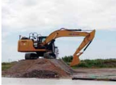
燃料消費の原因となる無負荷時の余剰なエンジン回転を省き、負荷によらず一定のエンジン回転を保つ「アイソクナロス制御」を採用することで、無負荷～軽負荷での燃料消費量を低減しています。また「高効率ブームエネルギー再生システム」では、ブーム下げ時に油圧再生回路が機能するとともに、エンジン回転およびポンプ流量を抑えることで余分な燃料消費を抑えています。緻密なセンシングを行い場面に応じて最適な制御を行うシステムを搭載したEシリーズ油圧ショベルは従来機と同等の時間当り作業量を維持しつつ燃料消費量を約10%低減しています。また、標準モニタを使用する2Dガイダンス仕様も対応可能です。
