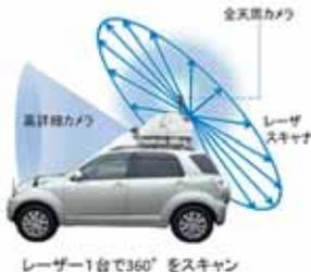
レーザースキャナで取得した反射強度を含む3次元データ(点群データ)を使用して、主に1/500レベルの数値地形図データを作成する技術です。従来は、トータルステーションで行っていた現地作業を、車両で走行しながらのレーザー計測に変えることができました。また、従来は写真上で行っていた図化作業を、高密度な反射強度点群上で行うことができるようになりました。これによって、工期を短縮し、経済性を大幅に向上することが可能となりました。
