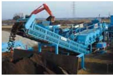
本技術は、土質性状の異なる2種類あるいは3種類の建設発生土を組合せて混合処理（粒度調整や強度改善）し、利用用途に応じた品質の盛土材を製造するものである。また、混合処理目的により石灰・固化材を添加することも可能である。本技術の利用により、従来処分していた「不良土」を有効活用することができる。
