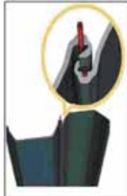
**Jポケットパイル®は、鋼矢板継手部底面に凹溝を設けて継手止水材を保護し、遮水性を高めた鋼矢板です。**
