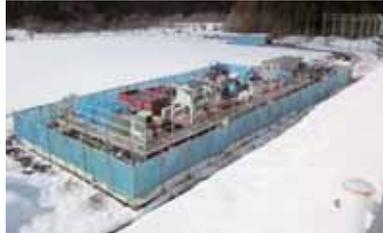
高性能洗浄装置を用いた汚染土壌の除染および減容化技術
