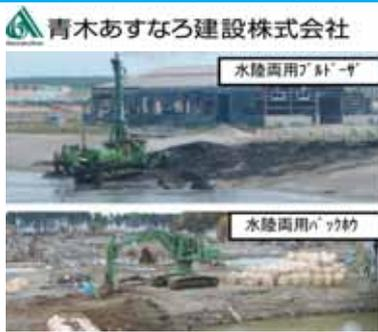
**水陸両用機械工法は浅水域を作業領域とし、東日本大震災でも被災した沿岸部各所で稼働している。**
